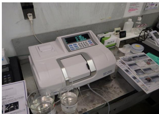
卓上型濁色度計 水質試験室(石川浄水場)
