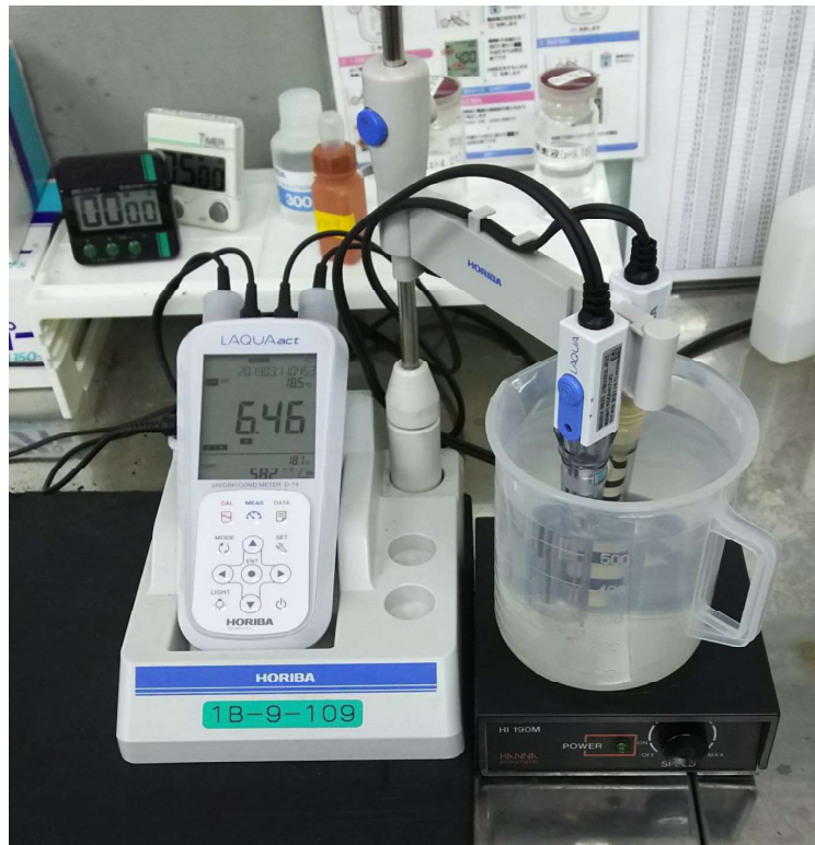
pH・電気伝導率計 水質試験室(石川浄水場)
