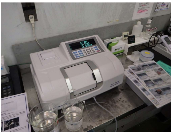
卓上型濁色度計 水質試験室(石川浄水場)
