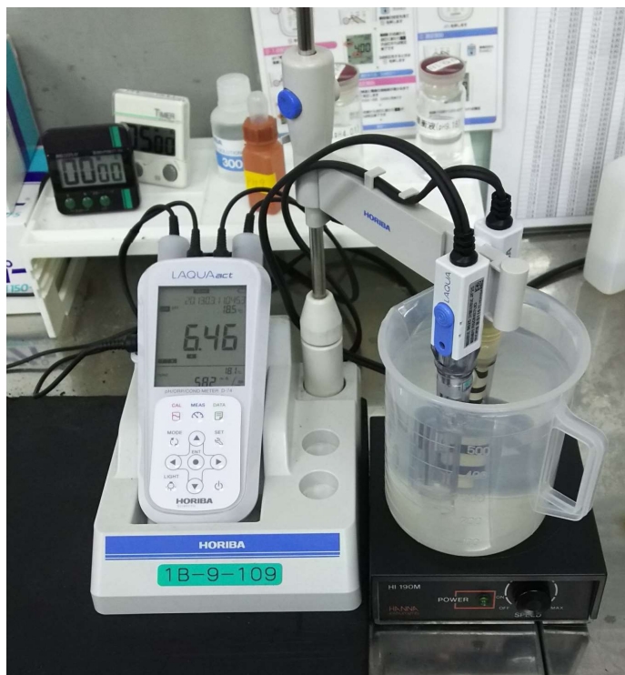
pH・電気伝導率計 水質試験室(石川浄水場)
