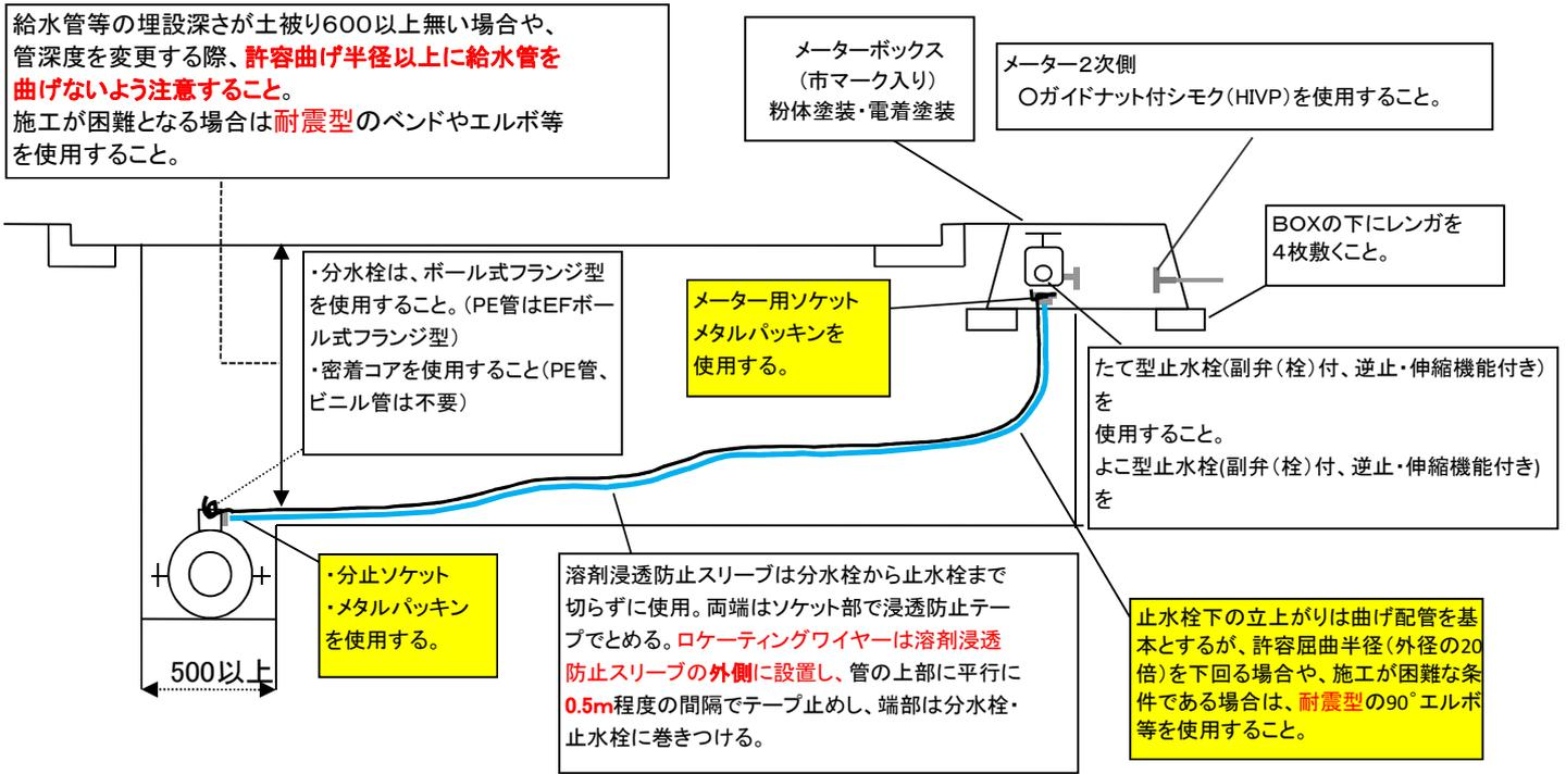
**各継手については、耐震型ワンタッチ継手を使用すること。(インコア打ち込み型や内蔵型など、メーカーにより異なる)**
